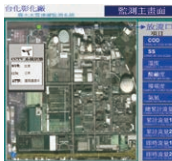
彰化廠區放流水自動連續監控作業系統
